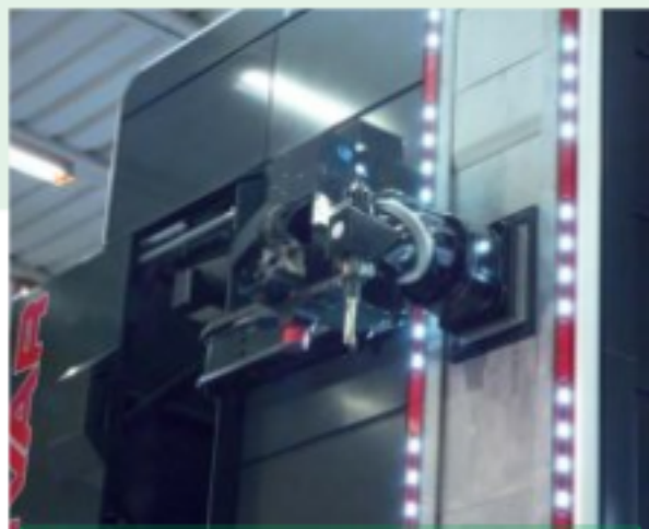
Manœuvre de changement d'outil à partir du magasin intégré à la colonne.
