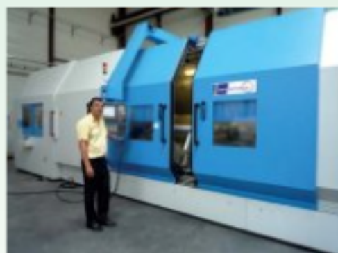
Bruno Gauthier, responsable « Grands comptes » de l'entreprise, devant le tour Johnford ST130 reconverti à la ultra-haute pression par les soins de l'équipe Omnitechnique.
