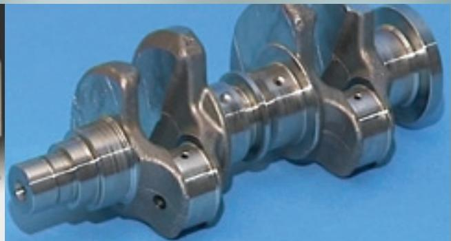
Mit der Parallelbearbeitung von bis zu drei Werkstücken in einem Zentrum bieten die Tiefbohrzentren für PKW-, LKW und Grosskurbelwellen höchste Produktivität.
