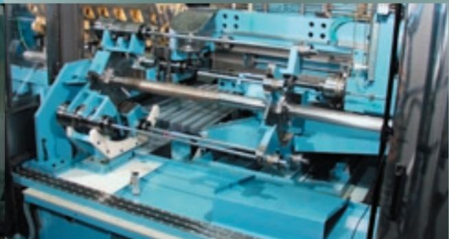
Die BW 300 und BW 400. Für Sonderapplikationen wie das BTA-Bohren von Druckwalzen, Papierwalzen, Endstücken von Bohrgestängen für Erdölbohrungen, Rohr-
